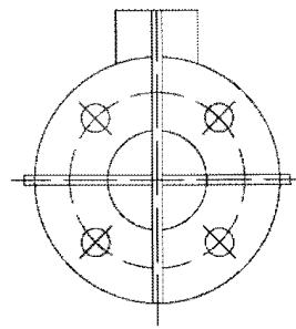
Рисунок 6.1. Измерительный шаблон для проверки отклонений
