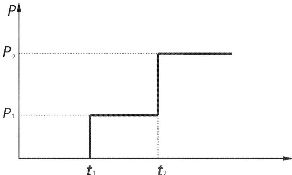
$P_1$  - давление пуска;  $P_2$  - давление рабочее;  $t_1$  - минимальная температура воздуха, при которой допускается пуск трубопровода под давлением  $P_1$ ;  $t_2$  - минимальная температура, при которой сталь и ее сварные соединения допускаются для работы под давлением в соответствии с требованиями Приложения А, таблица А.1
