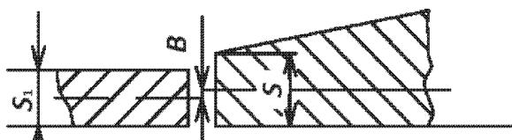
Рисунок 12.2. Смещение кромок листов в стыковых продольных соединениях
